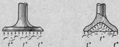
Тюльпанообразный клапан нагревается сильнее плоского
