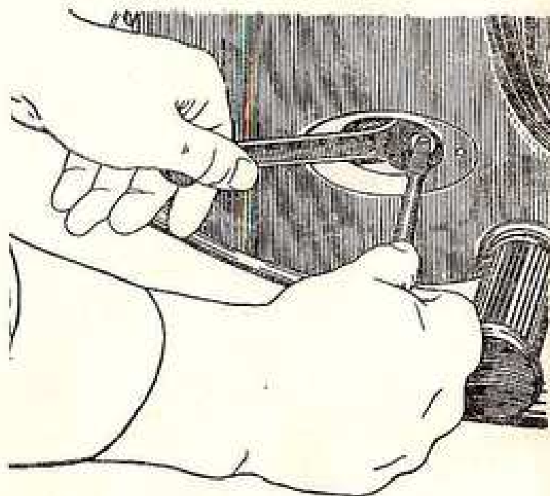
Рис. 8. РЕГУЛИРОВКА АВТОМАТИЧЕСКОГО ВЫЖИМА СЦЕПЛЕНИЯ
