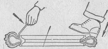
Рис. 81. Демонтаж шины колеса
