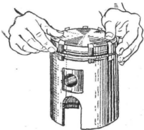
р.ис. 30. Снятие поршневых колец с поршня.
