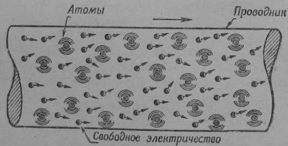
Рис. 116. Схема движения свободных электронов по проводнику под влиянием электрического поля
