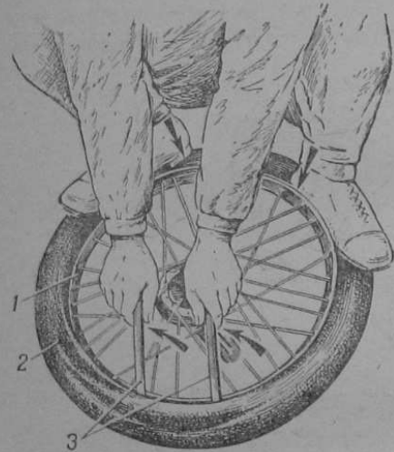
Рис. 269. Снятие шины: 1 — обод; 2 — покрышка; 3 — монтажные лопатки
